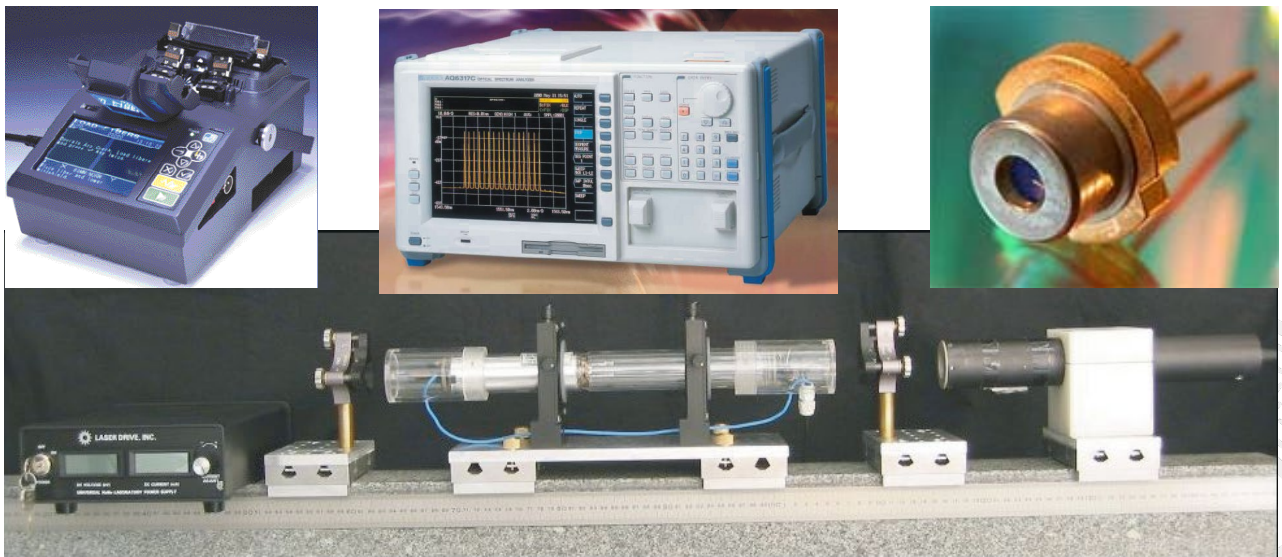
Oben v.l.n.r.: Fusionssplicein für SM-Glasfasern, Optischer Spektralanalysator, Laserdiode Unten: Experimenteller Helium-Neon-Laser mit Hochspannungsnetzteil und externem Resonator
